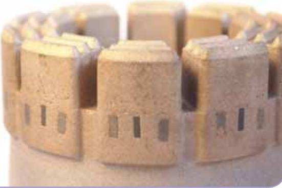
La couronne imprégnée DATC présente sur sa face de coupe une couche métallique imprégnée de diamants. De fins cristaux de diamants sont intimement mélangés à une poudre métallique, appelée matrice. Cet ensemble est ensuite traité thermiquement afin d'assurer la compaction et la liaison métallurgique, ainsi que la fixation sur le corps en acier de la couronne.
